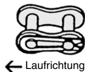
Fig. 8.3 Richtiger Einbau eines Verschlussgliedes mit Schnappfeder.
